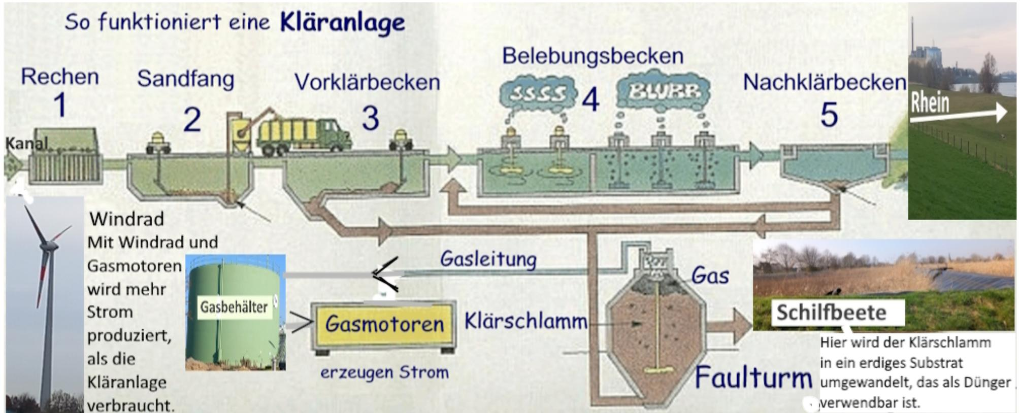
1. Aus dem Abwasserkanal wird das Abwasser in den **Rechen** gepumpt. Der Rechen ist ein **großes Sieb**, mit dem die groben Teile (Papier....) aus dem Abwasser **herausgeholt** werden.
